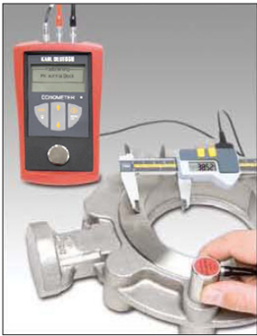
通过电子卡尺得到的壁厚值输入设备后，测量材料的声速
