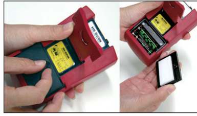
电池的拆卸和更换
